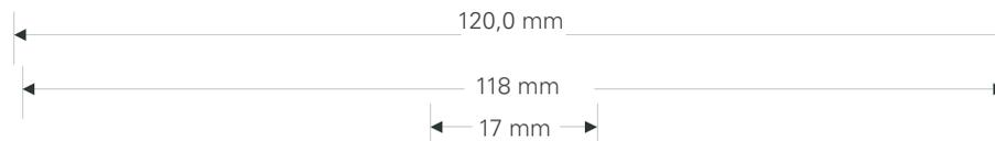
Bedruckbarer Bereich von 17 mm bis 118 mm
